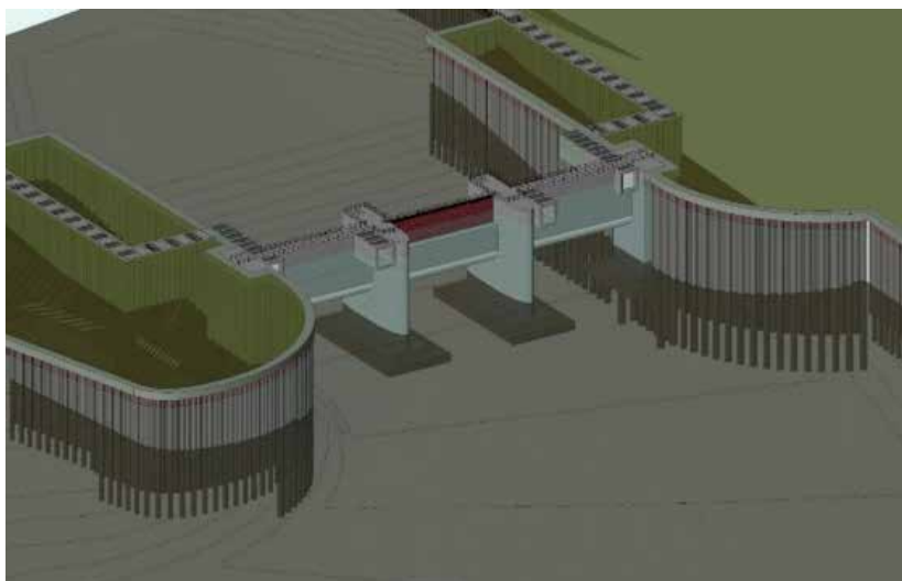
Figuur 4 Visualisatie van de zoutdam (links) en het deel daarvan boven water (rechts)
