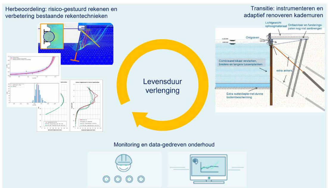
Figuur 1: Mogelijke aanpak levensduurverlenging bestaande kadeconstructies
