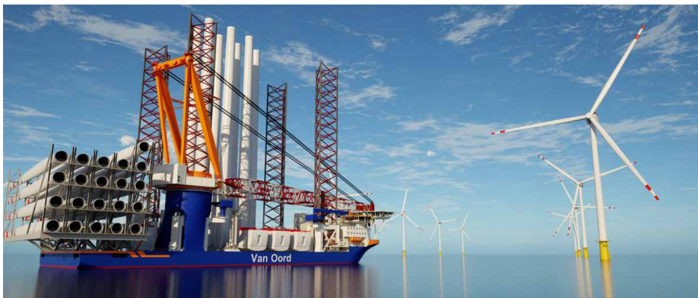
Figuur 4: In aanbouw JUV Boreas, investering Van Oord voor installeren Turbines 20 MW+ en fundaties
