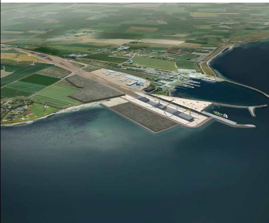
Figuur 4: Artist impression bouwput en werkhaven Fehmarn (Bron: RAT/Schonherr)
