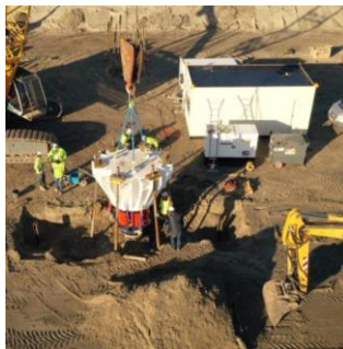
Proef funderingspalen Maasvlakte Rotterdam
